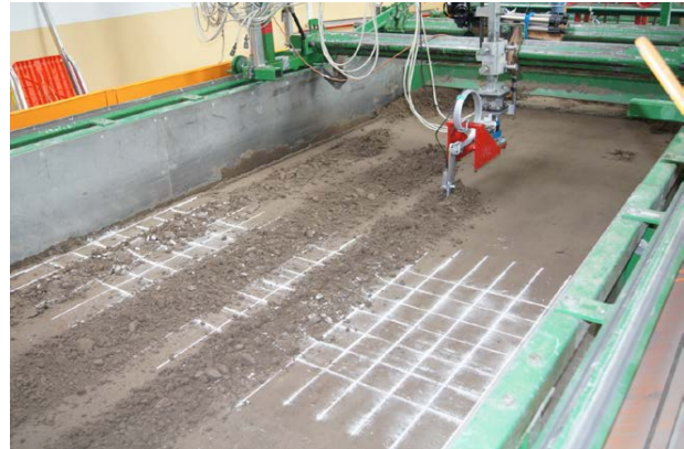
Billede 3: Laboratorieforsøg fra Warswa University of Life Science i Polen, hvor gåsefodsskær og AgrolIntellis nye L-skær sammenlignes. Kilde: Projektet NEWCUT.
